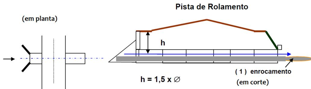
5.2.2. Muros de Ala e caixas de captação para tubulações: em alvenaria de tijolos comuns, e estrutura de concreto armado, conforme detalhe em projeto.
